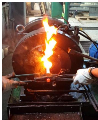
Рис. 2. Ковка стального прутка диаметром 18 мм на радиально-ковочной машине РКМ-1 (В2129.01)
