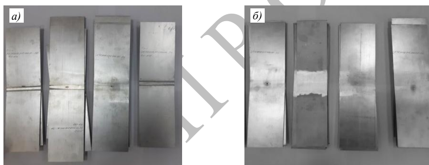
Рис. 3. Сварные конструктивно-подобные образцы, выполненные лазерной сваркой (а) и сваркой трением с перемешиванием (б)
