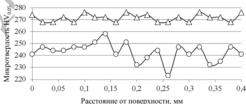
Рис. 10. Распределение микротвердости по толщине образцов из стали ВНС-78 после ротационнойковки на радиально-ковочной машине (Δ) и поперечно-винтовой прокатки (○) с последующим отжигом
