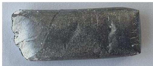
Рис. 4. Фрагмент образца 1 из сплава ВМД16 после проведения огневых испытаний под воздействием пламени газовой горелки
