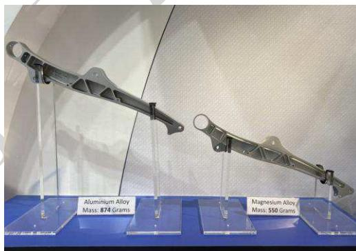
Рис. 1. Задние стойки сиденья из магниевого (справа) и алюминиевого сплавов (слева) авиационного пассажирского кресла
