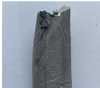
Рис. 3. Фрагмент образца 2 из сплава ВМД16 после проведения огневых испытаний под воздействием пламени газовой горелки
