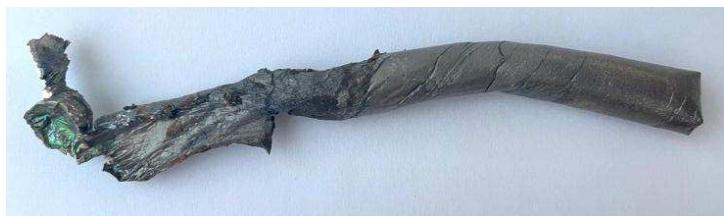
Рис. 2. Образец 4 из сплава ВМД16 после проведения огневых испытаний под воздействием пламени газовой горелки
