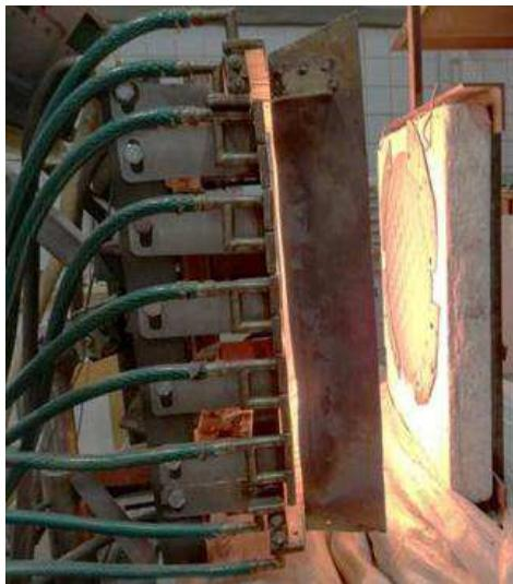
Рис. 1. Общий вид стенда лучистого нагрева во время испытания
