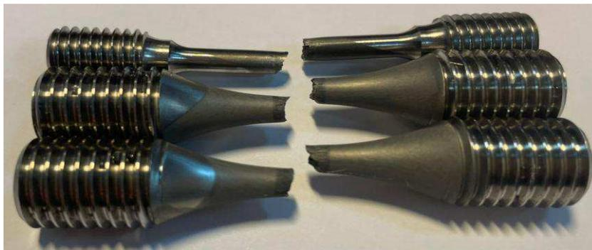
Рис. 4. Разрушенные сварные образцы после испытаний на растяжение и малоцикловую усталость из сплава VT22M
