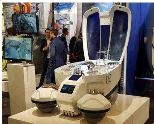
Робот Flappybot для автоматизированной выкладки препрега [25]
