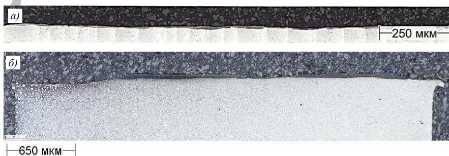
Рис. 4. Микроструктуры поверхности образцов составов 1 и 2 после триботехнических испытаний
