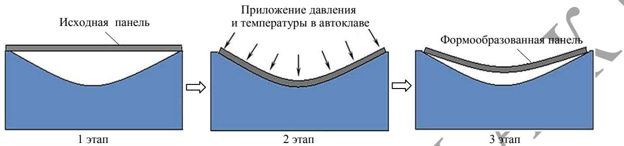
Рис. 1. Изменение формы панели обшивки в процессе автоклавного формования
