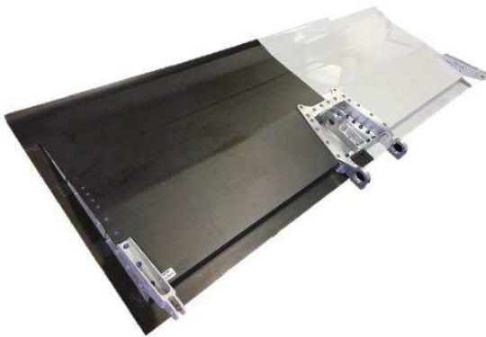
Рис. 8. Интерцептор крыла самолета Airbus A320neo [29]
