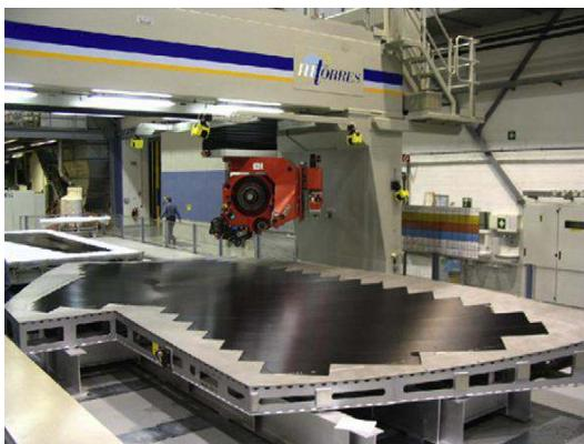
Рис. 1. Пример установки ATL на горизонтальной раме [10]
