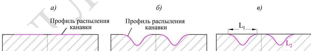
Рис. 6. Профиль распыления канавки новой (*а*) и «наработанной» (*б*) мишени и сравнение профилообразующих линий канавок (*в*) новой и «наработанной» мишеней
