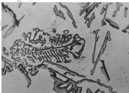
Рис. 2. Форма кристаллизации W-фазы ( $Al_4Cu_2Mg_8Si_7$ ),  $\times 500$  [11]
