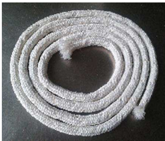
Рис. 9. Образец гибкого уплотнительного шнура с оплеткой из термостойких оксидных нитей
