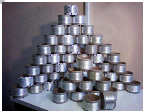
Рис. 7. Паковки многофиламентной нити из волокон оксида алюминия
