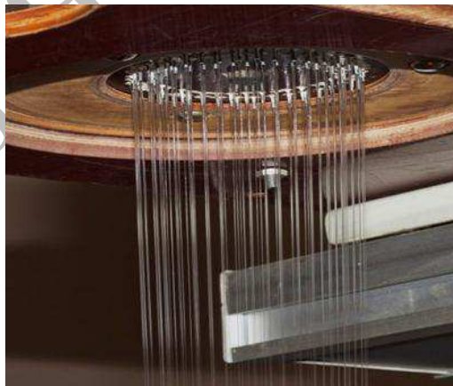
Рис. 1. Экструдирование через фильеру формовочного раствора прекурсоров для получения оксидных волокон
