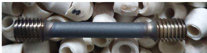
Рис. 2. Общий вид образца из модельного титанового сплава с покрытием
