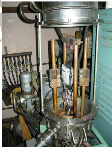
Рис. 1. Общий вид вакуумной камеры экспериментальной установки по измерению теплопроводности теплоизоляционных материалов стационарным методом «пластины»
