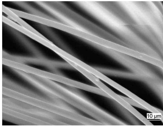
Рис. 3. Размеры и качество поверхности непрерывных волокон
