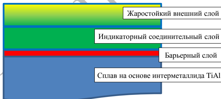
Рис. 1. Конструкция многослойного ионно-плазменного конденсационно-диффузионного покрытия
