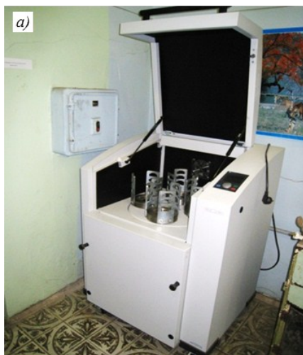
Рис. 1. Оборудование для механической активации исходных смесей: а – планетарная мельница Retsch PM 400; б – барабан мельницы с рабочими телами (крышка снята, на ней видны клапаны вакуумирования и наполнения аргоном)
