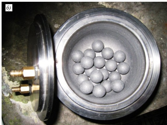
Рис. 1. Оборудование для механической активации исходных смесей: а – планетарная мельница Retsch PM 400; б – барабан мельницы с рабочими телами (крышка снята, на ней видны клапаны вакуумирования и наполнения аргоном)
