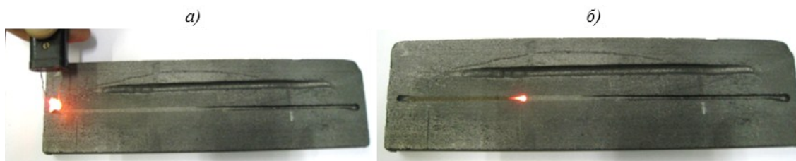
Рис. 2. Реакции в смеси, лежащей в желобе лабораторной оснастки: а – инициация реакции электронагреваемой спиралью; б – движение фронта реакции
