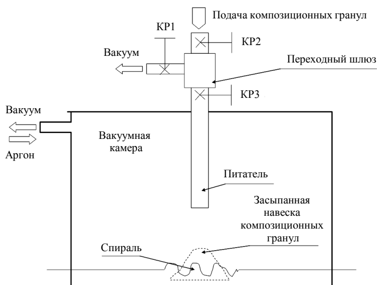
Рис. 3. Схема вакуумного реактора
