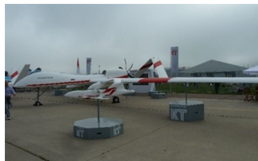
БПЛА «Орион» (РФ) с поршневым двигателем Rotax 914 (115 л. с.)
