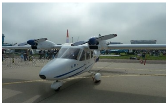
Многоцелевой самолет МАИ-411 (РФ) с поршневым двигателем Rotax 912S (100 л. с.)
