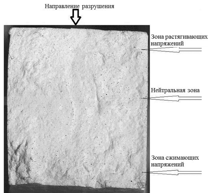
Рис. 7. Макроизображение ( \times 20 ) поверхности излома образца состава 2
