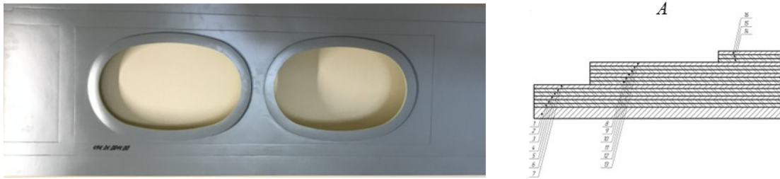
Рис. 8. Конструктивно-подобный образец фрагмента обшивки нижней панели крыла из гибридного материала
