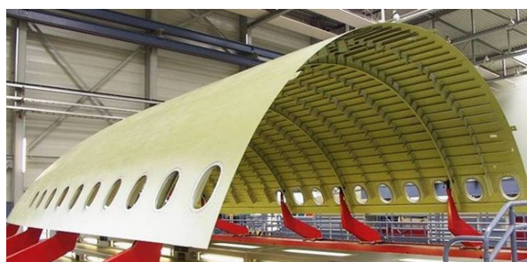
Рис. 5. Обшивка фюзеляжа из материала GLARE
