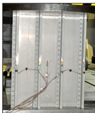
Рис. 7. Конструктивно-подобный образец гибридной панели крыла с обшивкой из слоистого материала на базе листов из алюминий-литиевых сплавов и композитов
