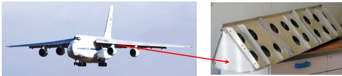
Рис. 1. Конструктивно-подобный образец носовой части крыла самолета Ан-124 с обшивками из АЛОРа Д16/41 [11, 12]
