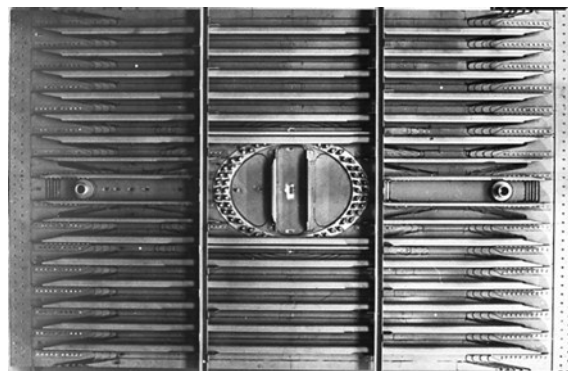
Рис. 2. Панель крыла из материала ARALL для самолета F-27 компании Fokker
