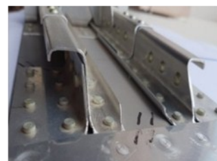
Рис. 6. Конструктивно-подобный образец панели фюзеляжа с обшивкой из алюмокомпозита СИАЛ-3-1Р и стрингерным набором из сплава 1441
