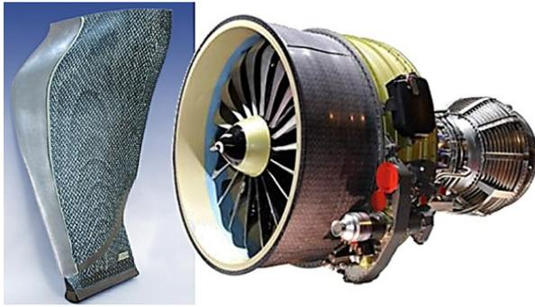
Рис. 14. Лопатка из углепластика на основе 3D-тканой преформы и двигатель серии LEAP-X
