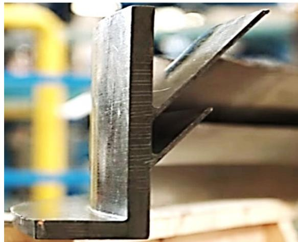
Рис. 15. Композитный шпангоут из углепластика, выполненный на основе 3D-преформы фирмой SONACA (Бельгия)
