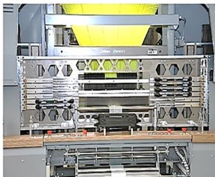
Рис. 7. Лентоткацкий станок фирмы «Магеба» (ФРГ) с перемещением челнока рапирой
