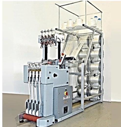
Рис. 4. Рапирный лентоткацкий станок фирмы «Магеба» (ФРГ)
