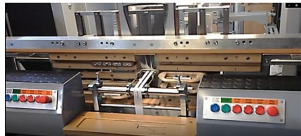
Рис. 5. Лентоткацкий станок фирмы «Магеба» (ФРГ) с приводом челнока зубчатой рейкой
