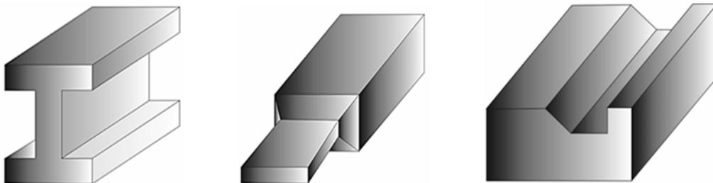
Рис. 11. Некоторые варианты толстостенных объемных трехмерных структур, получаемых методом 3D-ткачества
