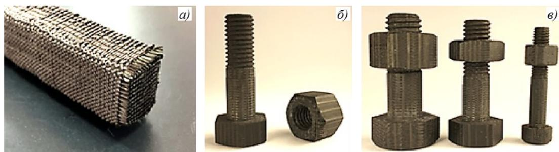
Рис. 13. Цельнотканая преформа и болтовые изделия из углепластика на ее основе (ООО НПП «Текстор»)
