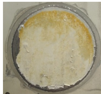
Рис. 9. Внешний вид участка гальванотермического покрытия Ц2.О2.Ц2.О1 на стали 30ХГСА после проведения его анодной обработки в электрохимической ячейке
