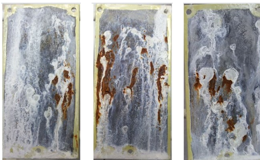
Рис. 3. Внешний вид гальванотермического покрытия, сформированного при термообработке при 200°С в течение 2 ч, после 400 ч ускоренных коррозионных испытаний в КСТ
