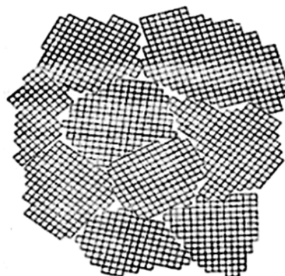
Рис. 2. Схема структуры поликристаллического металла [15]
