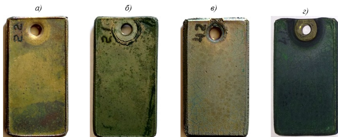
Рис. 2. Внешний вид хромированных образцов после термообработки при температуре 400 (а, в) и 650°С (б, з) в течение 11 циклов:
