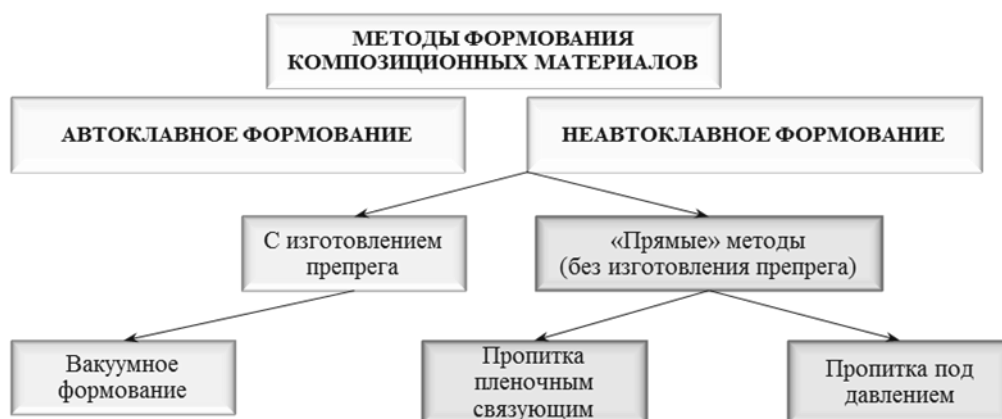
Рис. 1. Классификация технологий изготовления полимерных композиционных материалов
