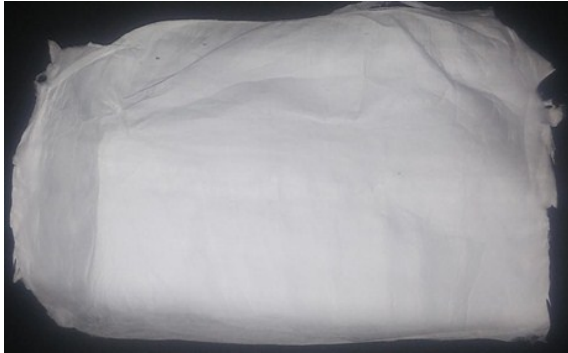
Рис. 3. Волокнистый материал, полученный методом электроформования со свободной поверхности
