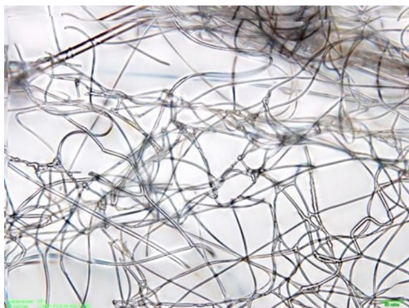
Рис. 6. Дендривидная структура электроформованного керамического волокна
