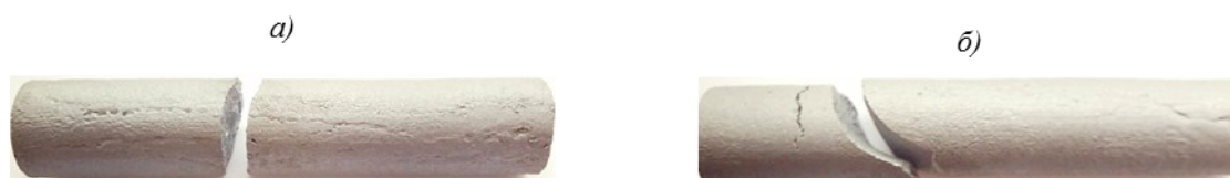
Рис. 8. Внешний вид излома образцов из сплава состава Cr–0,3% (по массе) Y, кристаллизованных без ЭМО (а) и с ЭМО (б)
