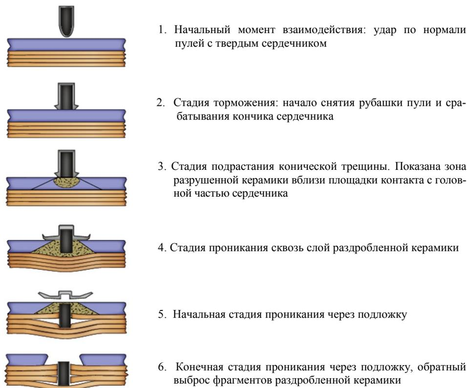
Рис. 2. Стадии взаимодействия высокоскоростного индентора с преградой на основе керамики [30]
