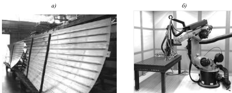
Рис. 10. Сварная панель крыла, выполненная с применением лазерной сварки из алюминий-литиевого сплава 1424 (а) и роботизированного технологического комплекса лазерной гибридной сварки Laser Weld 8R60 (б)
