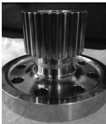
Рис. 2. Сварной роторный блок из сплава ВЖ172 конструкции АО «Климов»
