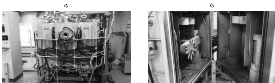
Рис. 8. Внешний вид (а) и рабочая камера (б) установки МАП-5 для нанесения ионно-плазменных покрытий на крупногабаритные детали, конструкции типа «блиск» и «блинк», сопловые лопатки и другие детали ГТД сложной геометрической формы
