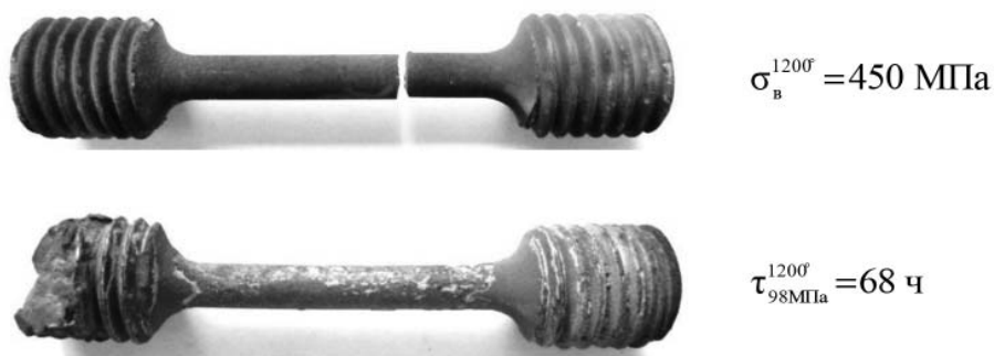
Рис. 8. Внешний вид образцов после испытания механических свойств из сплава на основе ниобиевой матрицы
