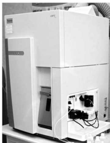
Рис. 3. Масс-спектрометр с индуктивно связанной плазмой iCAP Qc
