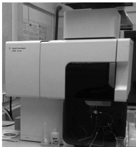
Рис. 2. Спектрометр Agilent 5100 (ИСП-АЭС)
