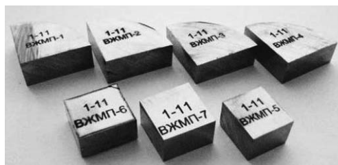
Рис. 5. Внешний вид комплекта стандартных образцов (СО)
