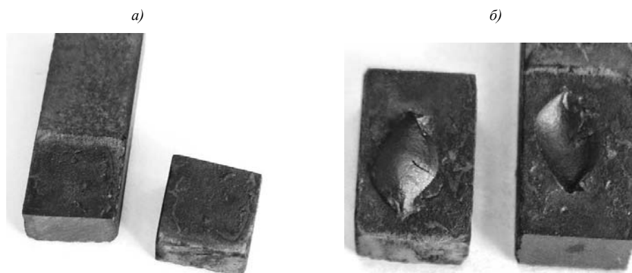
Рис. 8. Внешний вид образцов после проведения экспериментов по термоциклированию: а – отслоение точно по шву; б – отслоение с образованием лунки
