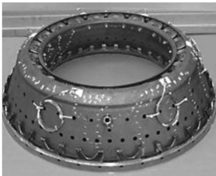
Рис. 2. Камера сгорания из керамического композиционного материала
