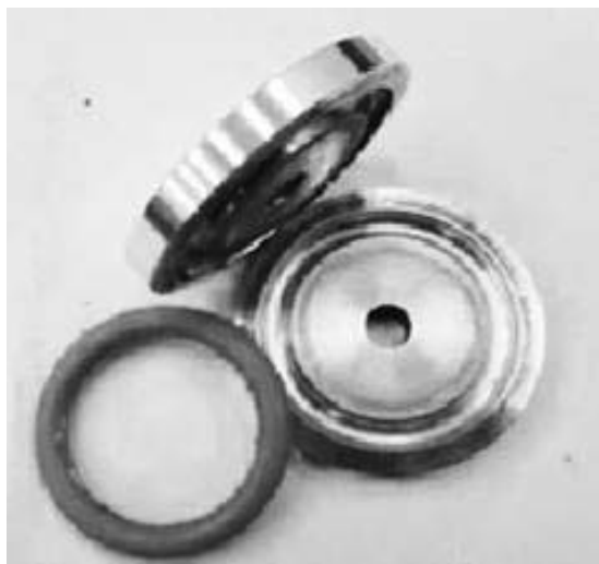
Рис. 9. Форма в разобранном виде с полученным уплотнительным кольцом
