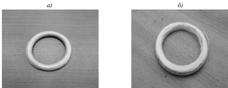
Рис. 10. Образец уплотнительного кольца до (а) и после нагрева (б)
