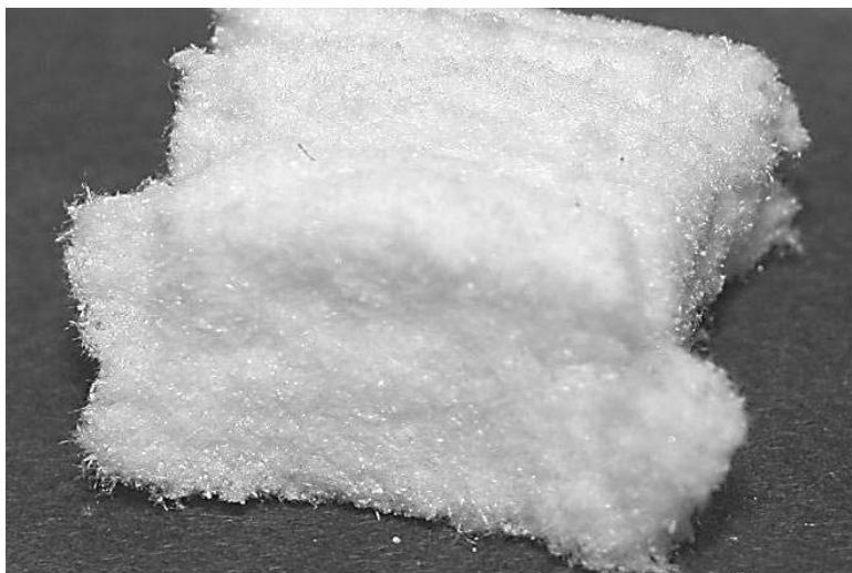
Рис. 6. Волокнистый мат из дискретного волокна на основе оксида алюминия
