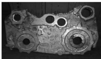
Корпус агрегата, отлитый в ПГС, из сплава ВМЛ20 (черновая масса 59 кг)
