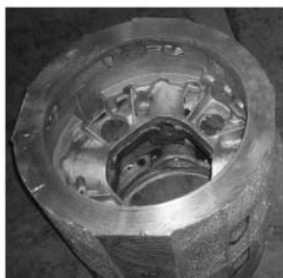
Отсек, отлитый в кокиль, из сплавов ВМЛ18 и ВМЛ20 (черновая масса 176 кг)
