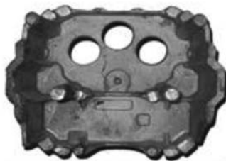
Кронштейн, отлитый в ПГС, из сплава ВМЛ18 (черновая масса 4,8 кг)
