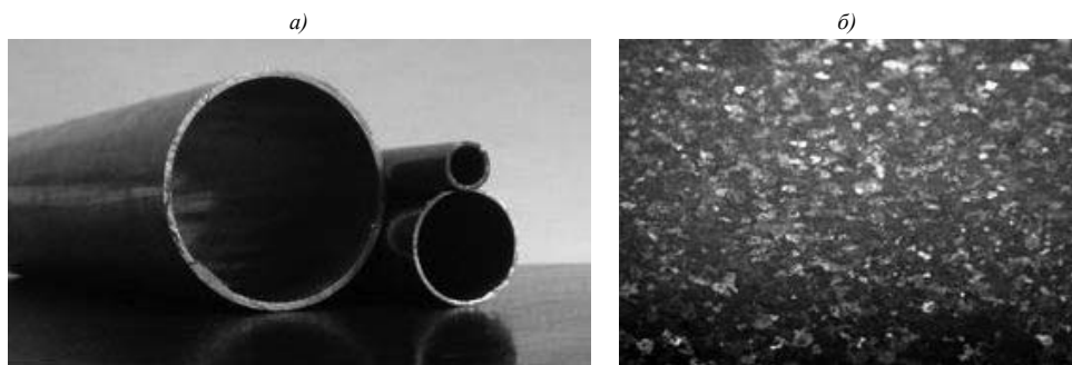
Рис. 4. Холоднодеформированные тонкостенные трубы: общий вид (а) и микроструктура (б – \times 50 )
