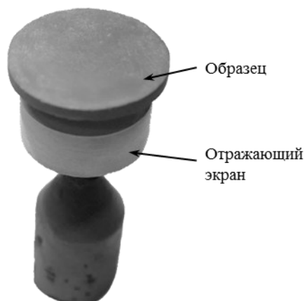
Рис. 4. Модель с образцом композиционного материала
