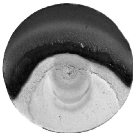
Рис. 9. Образец из керамического композиционного материала серии 3-2 после проведения испытаний
