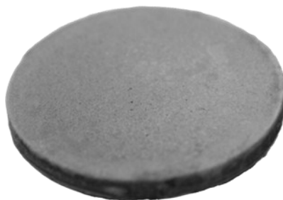
Рис. 3. Образец керамического композиционного материала диаметром 40 мм
