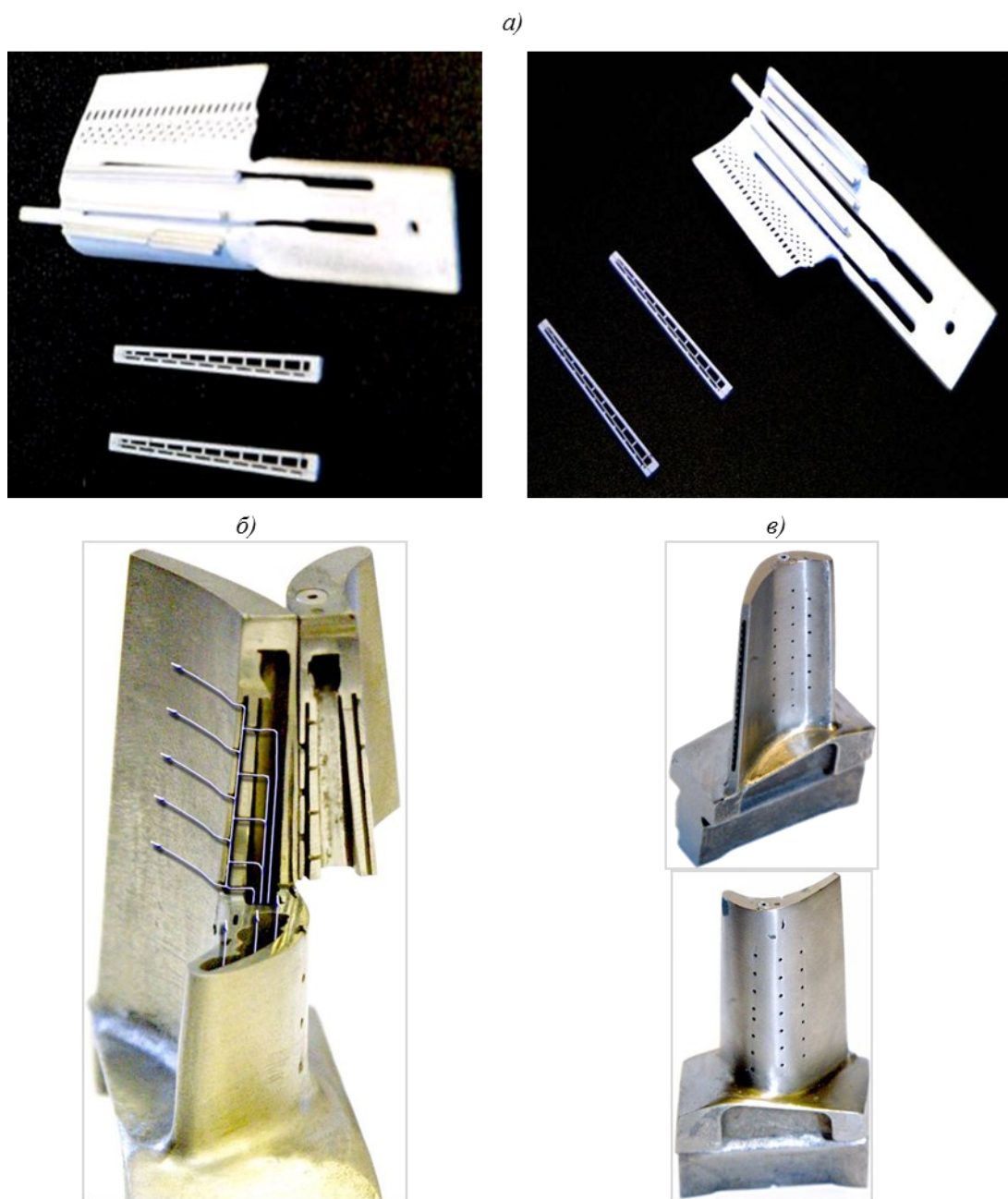
Рис. 4. Составной керамический стержень (а), модельная двустенная лопатка в разрезе (б) и общий вид со стороны корыта и спинки (в)
