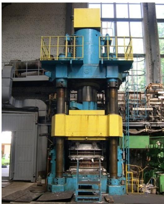
Рис. 1. Специализированный гидравлический пресс с усилием 1600 тс с регулируемой скоростью рабочего хода
