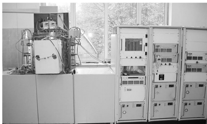
Рис. 3. Внешний вид установки УОКС-2 для осаждения керамических слоев магнетронным распылением
