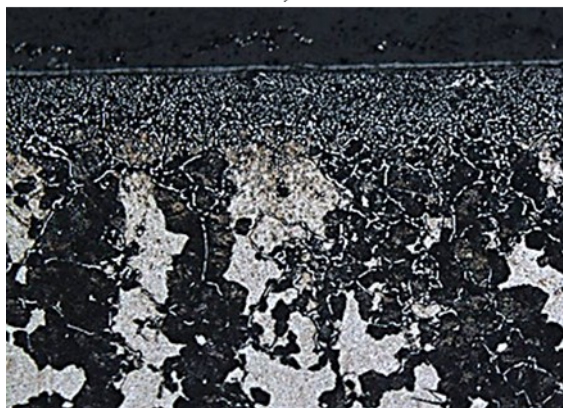
Рис. 1. Микроструктура ( \times 200 ) приповерхностной части цементованного слоя дисперсионно-твердеющей хромоникелевой стали мартенситного класса после цементации по режимам 1 (а), 2 (б) и 3 (в)
