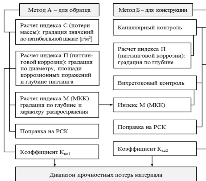
Рис. 3. Принципиальная схема расчета интегрального коррозионного коэффициента по методам А и Б
