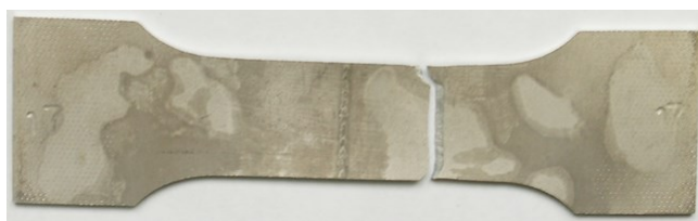
Рис. 6. Вид образца, разрушенного в процессе испытаний на растяжение (режим 5 – см. табл. 1)
