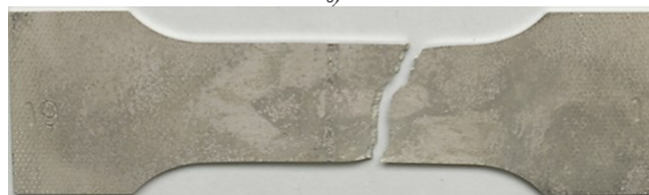
Рис. 5. Вид разрушенных в процессе испытаний на растяжение образцов со сварным швом:
