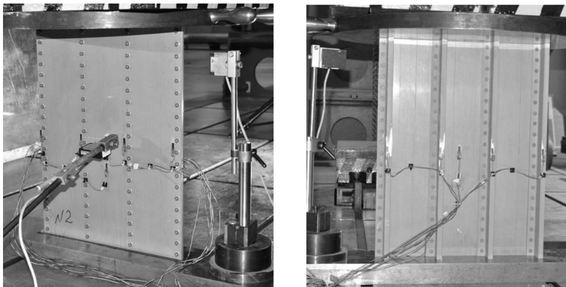
Рис. 4. Гибридная слоистая панель, установленная на опорную плиту испытательной машины
