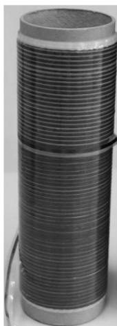
Рис. 2. Разрезанный препрег на бобине для применения при AFP выкладке
