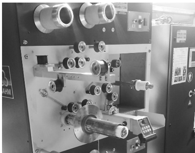
Рис. 7. Установка для перемотки разрезанного препрега компании SAHM
