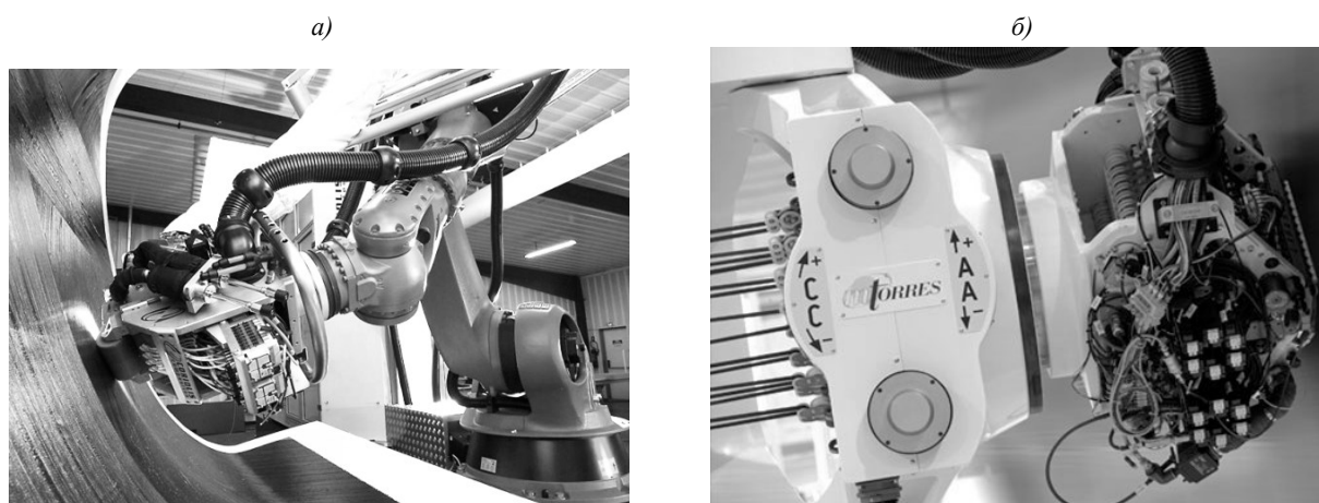
Рис. 1. AFP-комплексы для выкладки препрега фирм Coriolis (а) и M-Torres (б)
