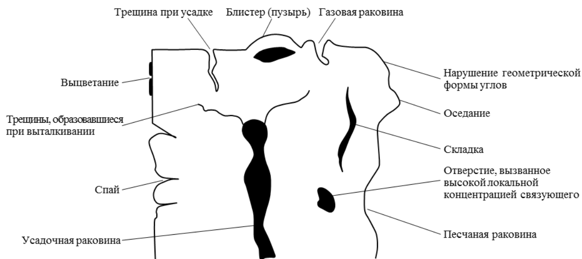
Рис. 2. Типы дефектов в заготовке изделия, полученной с помощью РИМ-технологии
