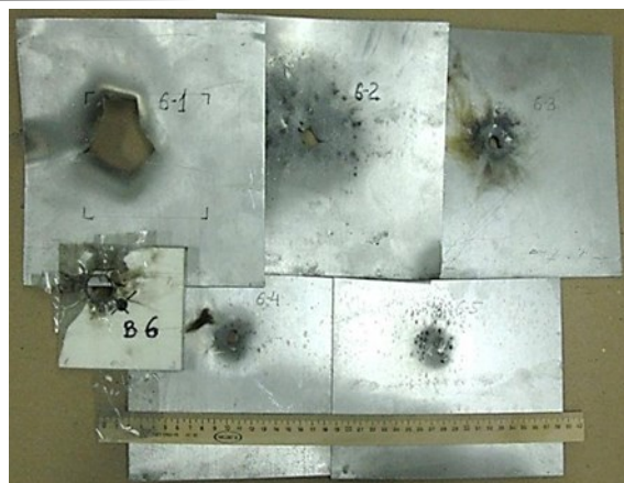
Рис. 4. Внешний вид керамического образца толщиной 8 мм и баллистических экранов после испытаний
