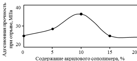
Рис. 1. Влияние содержания акрилового сополимера БМК-5 в эпоксидной матрице на адгезионную прочность при отрыве
