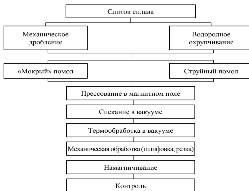
Рис. 1. Основные технологические этапы изготовления магнитов системы Nd–Fe–B
