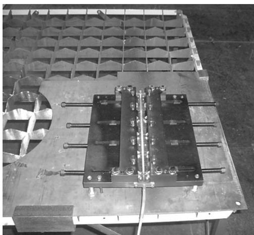
Рис. 3. Зажим свариваемых пластин в специальной технологической оснастке для сварки плоских образцов с системой защиты корневой части шва
