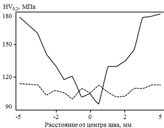
Рис. 7. Распределение микротвердости в сварных соединениях сплавов В-1461 (—) и 1424 (- - -)
