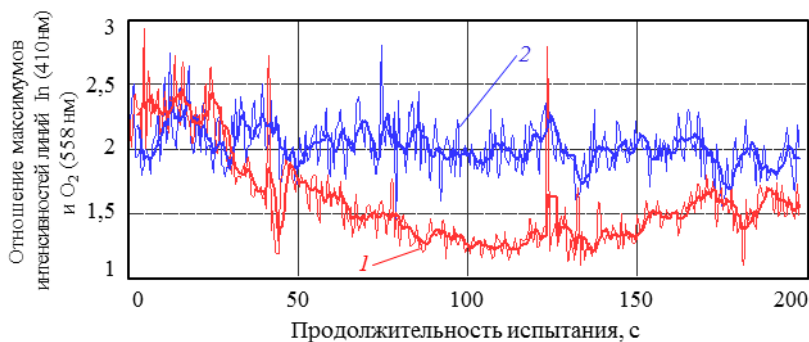
Рис. 3. Временная зависимость отношения максимумов интенсивностей контрольных линий индия и кислорода при ручном (1) и автоматическом (2) регулировании расхода кислорода
