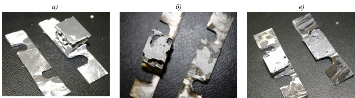
Рис. 4. Внешний вид образцов после разрушения: a – пеноалюминий–сталь; б – пеноалюминий–титан; в – пеноалюминий–никель
