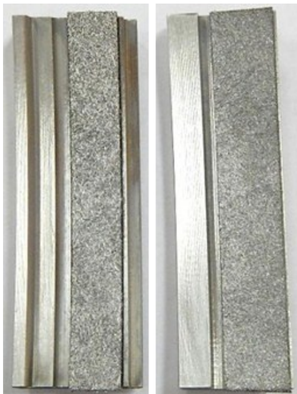
Рис. 1. Детали статора турбины авиационного ГТД с истираемым уплотнительным материалом из металлических волокон
