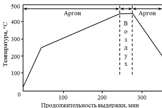
Рис. 3. Оптимальный термический цикл нагрева для удаления связующего
