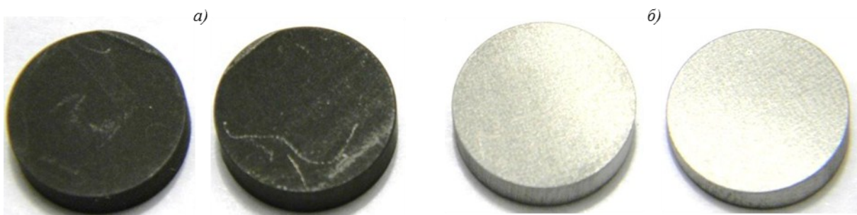
Рис. 6. Внешний вид образцов из сплавов ЖС36 и ВЖМ5 после цементации при 950°C и давлении 0,5+0,01 мм рт. ст. в течение 34 мин, без отжига (а), после вакуумного отжига при 1100°C в течение 30 мин (б)
