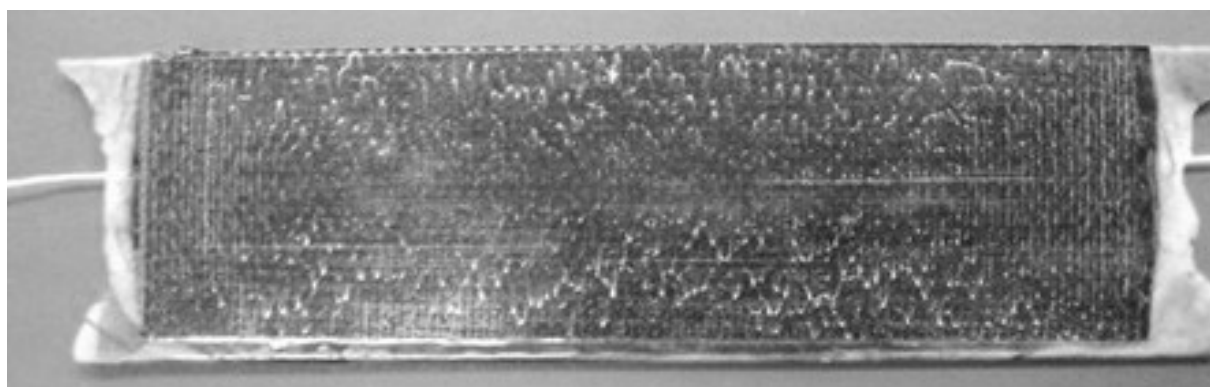
Рис. 3. Образец из углепластика интеллектуального типа с оптоволоконном
