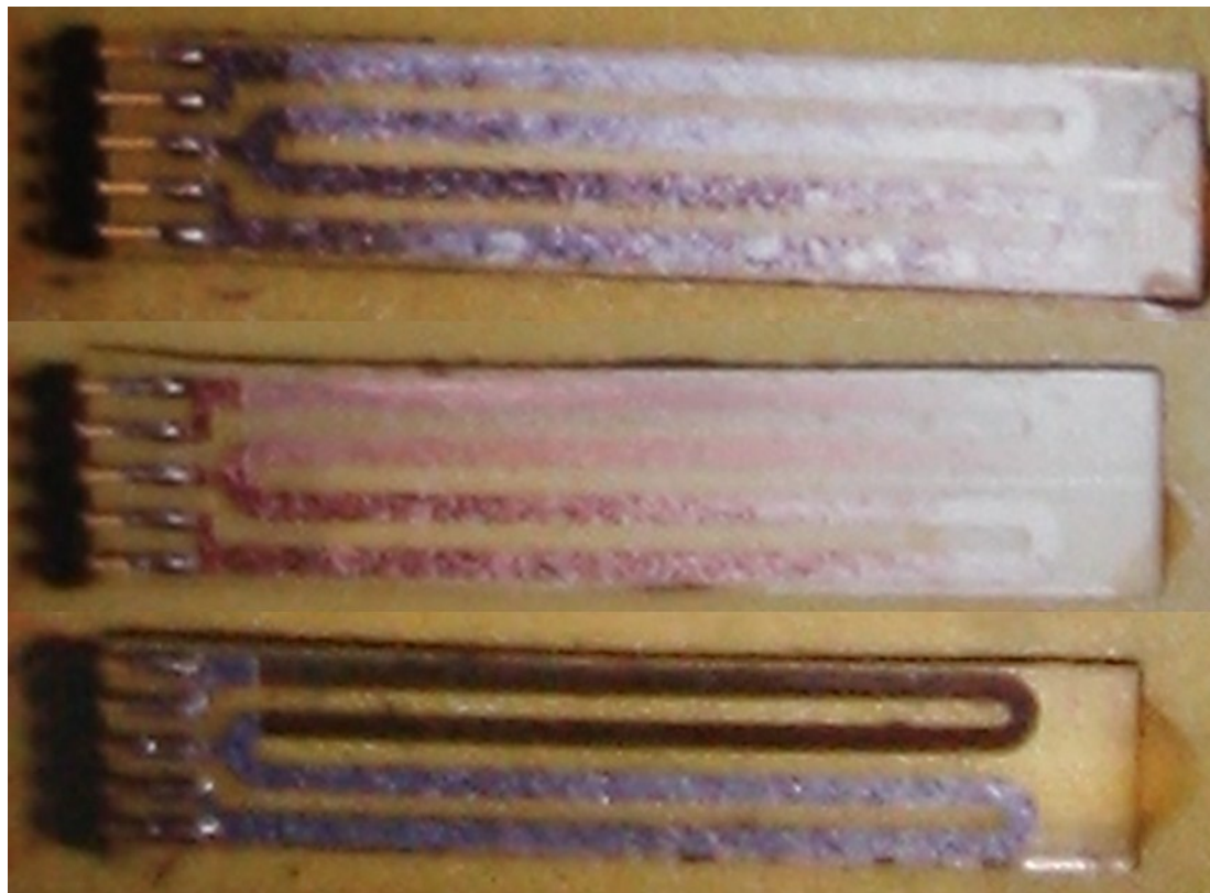
Рис. 9. Резистивные сенсоры коррозии, используемые для оценки коррозионной агрессивности атмосферы в туннелях г. Прага [69]
