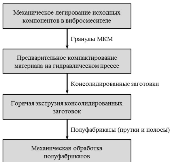
Рис. 1. Технологическая схема изготовления МКМ
