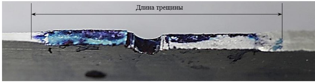
Рис. 3. Вид образца с введенной в излом контрастной жидкостью
